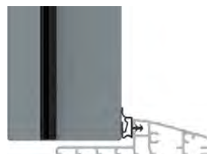
próg z uszczelnieniem
